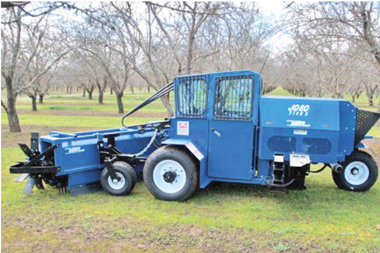
La amplia barredora autopropulsada JD80, con cabina de aire, es seis pulgadas (15,24 cm) más ancha que los modelos anteriores para una mayor comodidad del operador, mientras que el vidrio de seguridad tintado de ángulo amplio proporciona una vista panorámica de 360 grados.
