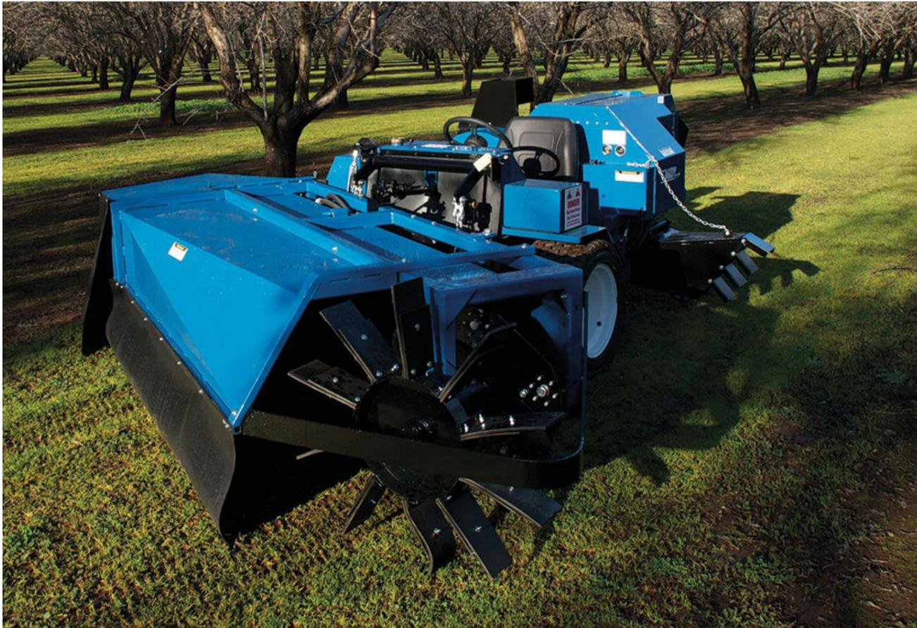
El perfil bajo aerodinámico de la barredora autopropulsada JD40 brinda una visibilidad excepcional para una operación de barrido fácil y sencilla debajo de ramas bajas. Se adapta a todo tipo de condiciones del terreno.
