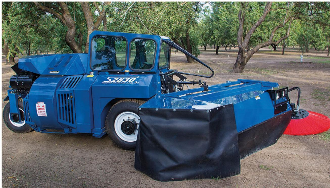
La barredora 2830 es una barredora de alta potencia y alta eficiencia con un soplador optimizado para una mayor capacidad de soplado.
