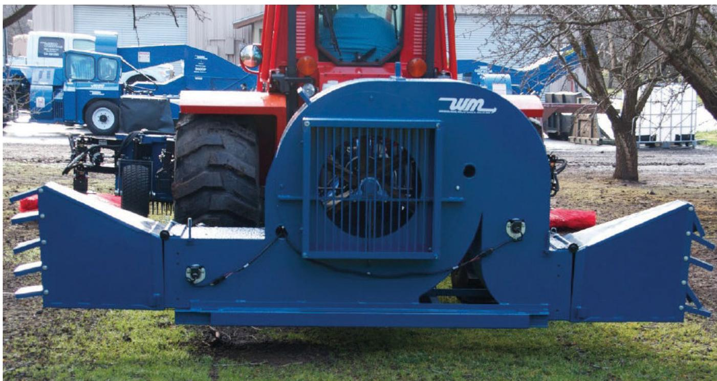
El soplador bidireccional B89 de Weiss McNair está diseñado para limpiar las hileras de árboles en las condiciones de cosecha más duras
