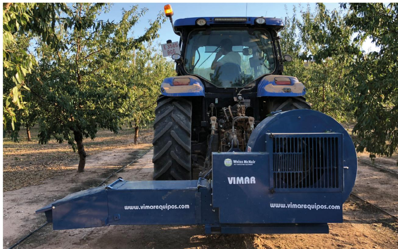
Con un enganche sencillo de 3 puntos y un eje de transmisión, el rendimiento superior del soplador unidireccional B-87 cumple todos los requisitos con un montón de reserva de poder de limpieza
