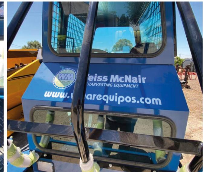
El motor está montado en la parte trasera, permitiendo una mejor visibilidad en todos los lados, un área de operador más silenciosa y refrigerada, un cabezal recolector más liviano que no se hundirá en la suciedad blanda, mientras que el motor montado en la parte trasera pone peso en las ruedas motrices para una mayor tracción.
