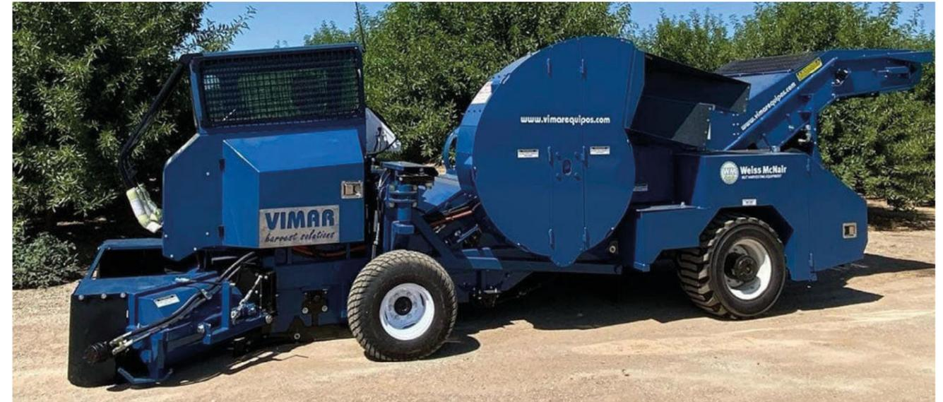
El Magnum X está propulsado por un motor diesel turboalimentado Tier 3 Cummins QSB4.5, 130HP
