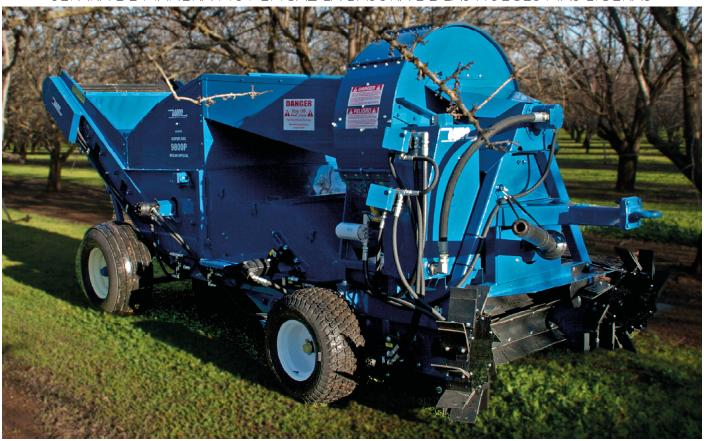
La opción de doble salida de descarga proporciona aberturas dobles para una operación más rápida durante condiciones pesadas y húmedas de basura, para una cosecha más rápida, más limpia y más rentable.
