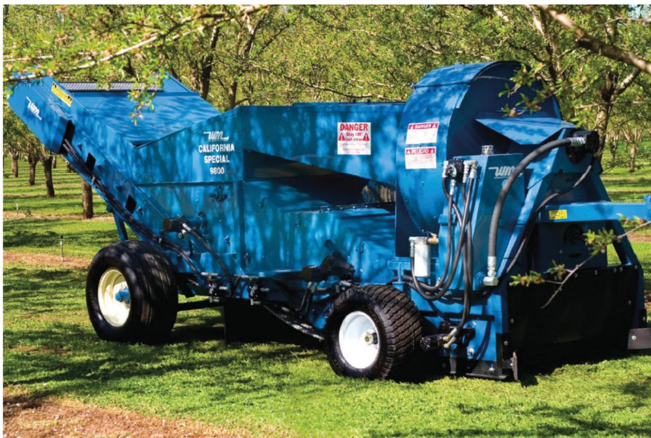
La larga cadena de suciedad intermedia permite que la suciedad se tamice a través de la cadena antes de que el ventilador de succión vacíe los residuos del cultivo para obtener menos polvo y una cosecha más limpia.
