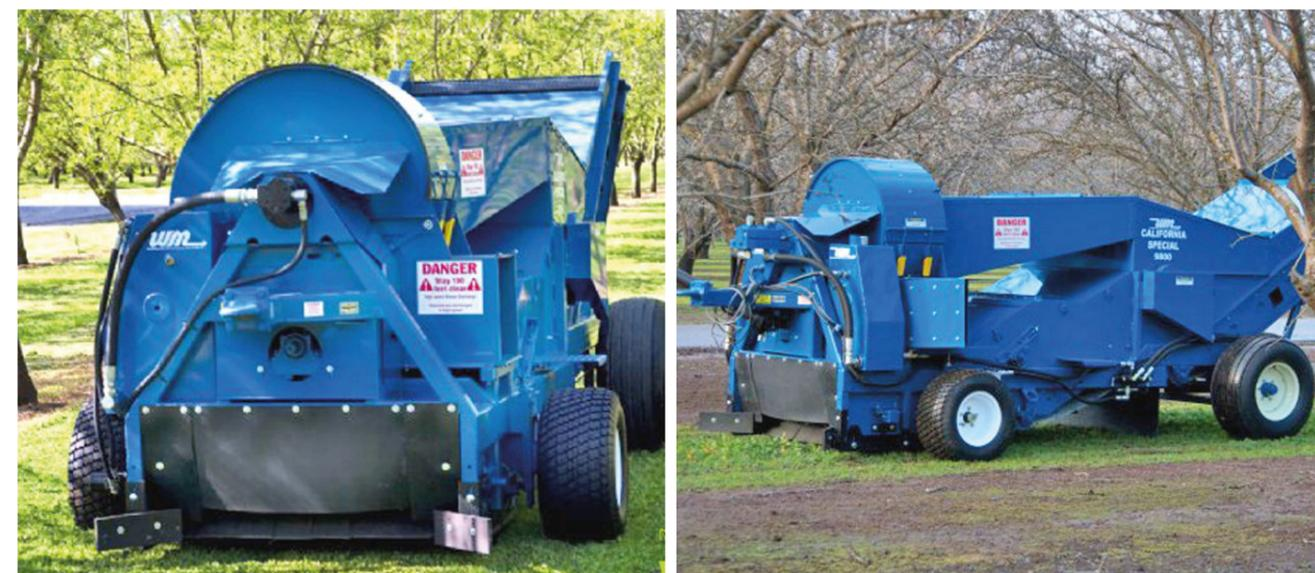
Los neumáticos de globo trasero extra grandes proporcionan la máxima flotación para una compactación reducida.
