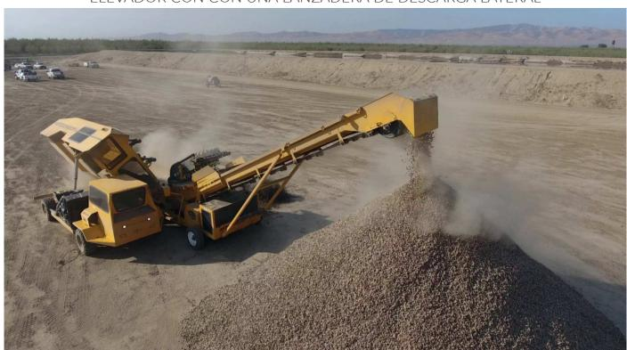
Creando una transferencia rápida y eficiente del producto recolectado desde la lanzadera al remolque que junto con una cinta adhesiva y un transportador transversal opcionales eliminan los palos y ramitas de su producto, garantizando que la capacidad de su remolque se maximice. Se opera desde una plataforma montada en un basculante accesible desde la cabina del transbordador lo que garantiza la seguridad del operador y reduce la fatiga.
