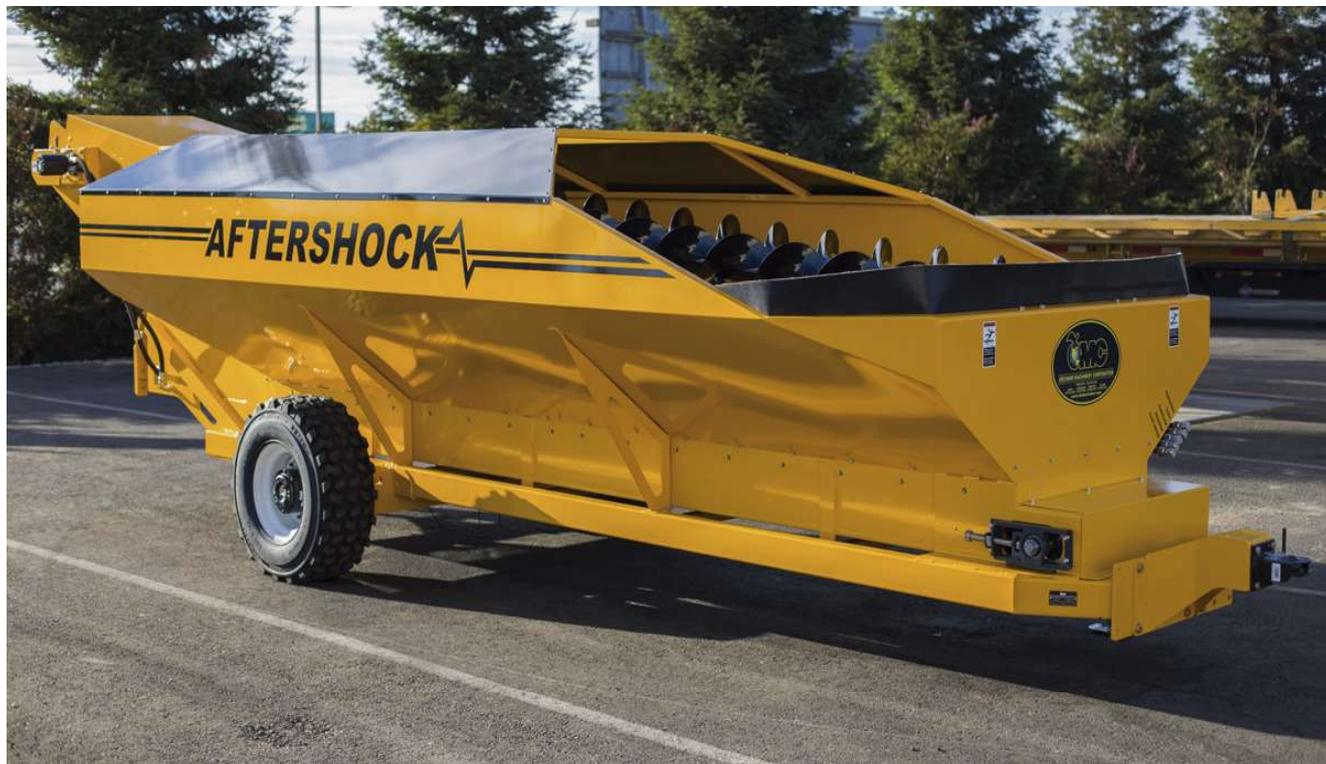
Un carro transportador con 525 pies cúbicos de capacidad, un sistema de entrega de cadena única con un cancho de transportador de 30 pulgadas y sinfines de nivelación doble. El CC-525 funciona especialmente bien cuando se combina con el sistema de agitador / receptor de dos piezas Shockwave Catsh-All VII de OMC configurado con un transportador de descarga a granel.
