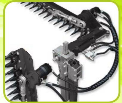
Tope superior con inclinación y rotación hidráulicas
