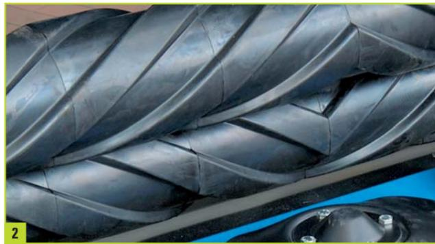
Die Rollenaufbereitung erfolgt durch das Verdichten und Aufbrechen des Pflanzenstengels, um die Wachsschicht zu öffnen und die gleichzeitige Trocknung mit dem Blatt zu ermöglichen.
