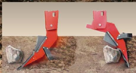
**con sistema de seguridad mecánico**
