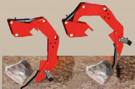
**con sistema de seguridad hidráulico**
