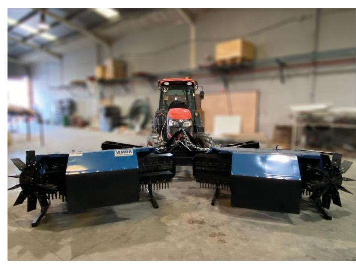
El comprobado V-Sweeper de entrega central para montaje en tractor Weiss McNair ahora se ofrece en un perfil bajo (LPV) para barrer en campos con hileras estrechas y árboles tupidos donde una barredora unidireccional no podría funcionar
